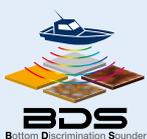
La technologie discrimination de fonds offre la possibilité, en complément des fonctions de sondeur classique, d'analyser et d'illustrer la nature du fond : vase, sable, gravier ou roche, dans des fonds de 5 à 100M.
